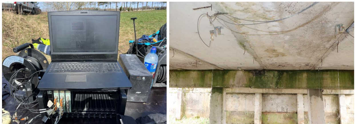
14 pav. Brüel & Kjær LAN XI dinaminės tyrimų sistema (kairėje) ir pjezokeraminiai žemo dažnio seisminiai keitikliai (dešinėje)
