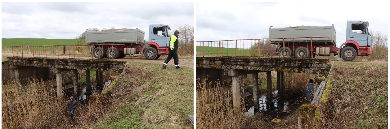
10 pav. Tilto statinio apkrovimo schema perdangos plokščių maksimaliems lenkimo momentams ir įlinkiams gauti (viršuje) ir tilto statinio apkrovimo savivarčio bandomąja apkrova bendri vaizdai (apačioje)
