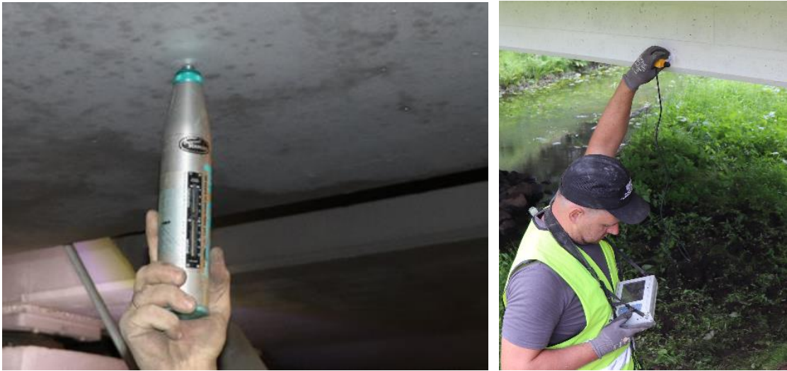
8 pav. Tiltų laikančiųjų konstrukcijų betono gniuždomojo stiprio tyrimai neardančiuoju būdu (kairėje) ir plyšių pločių matavimas (dešinėje)
