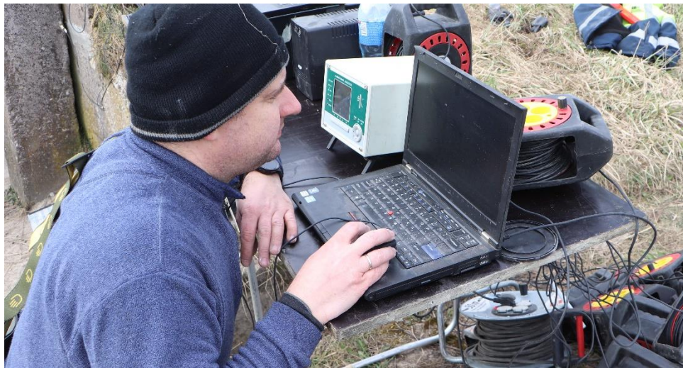
12 pav. Statiniams įlinkiams matuoti naudoti skaitmeniniai įlinkiomačiai (viršuje) ir jų sąsaja su imtuvu bei personaliniu kompiuteriu (apačioje)
